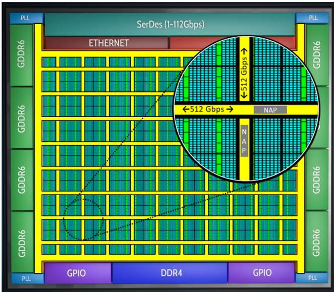
Fig. 4. 2D-NoC in Achronix Speedster7t FPGA
